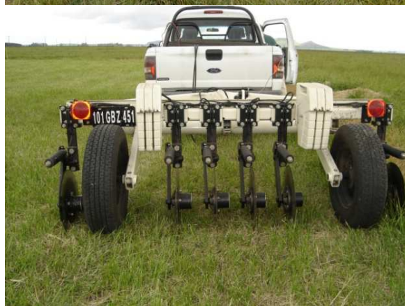
Figura 5. Herramientas para la delimitación de zonas de manejo (ZM). (a) GPS diferencial para la medición de la altimetría y (b) Equipo Veris 3100 realizando el relevamiento de CEa en una pastura de agropiro.
